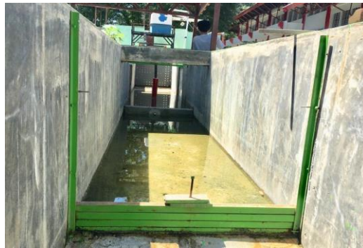
Gambar 4. Flume (Foto Langsung dari Laboratorium Hidrolika Fakultas Teknik Universitas Tadulako)
